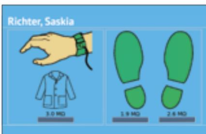
Schuhe und Handgelenkband können gleichzeitig gemessen werden. Konfigurierbare Messspannungen und Grenzwerte erlauben die optimale Anpassung an Ihre Anforderungen.
